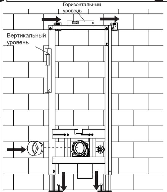
6 Зафиксировать раму инсталляции к полу и стене
