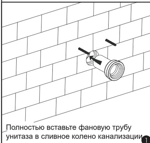
Полностью вставьте фановую трубу унитаза в сливное колено канализации **1**
