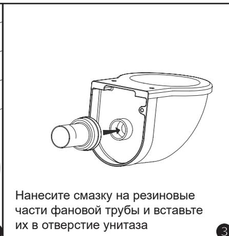
Нанесите смазку на резиновые части фановой трубы и вставьте их в отверстие унитаза **3**
