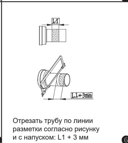
Отрезать трубу по линии разметки согласно рисунку и с напуском: L1 + 3 мм **6**
