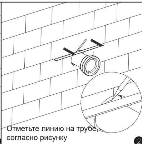
Отметьте линию на трубе, согласно рисунку **2**
