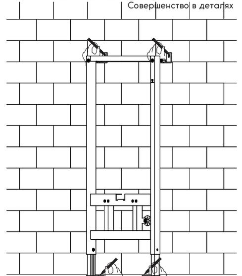
1 Вывернуть по вертикали и горизонтали, сделать разметку под отверстия крепления рамы инсталляции к полу
