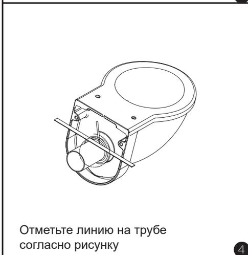
Отметьте линию на трубе согласно рисунку **4**
