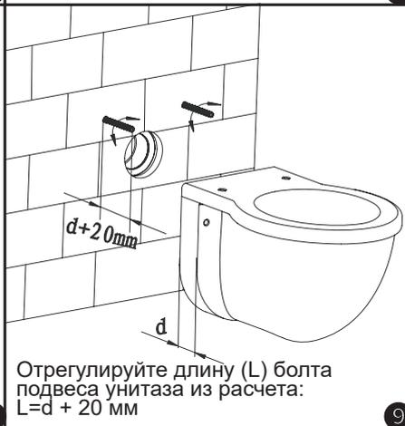
Отрегулируйте длину (L) болта подвеса унитаза из расчета:  $L = d + 20 \text{ мм}$  **9**
