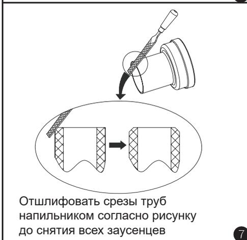
Отшлифовать срезы труб напильником согласно рисунку до снятия всех заусенцев **7**
