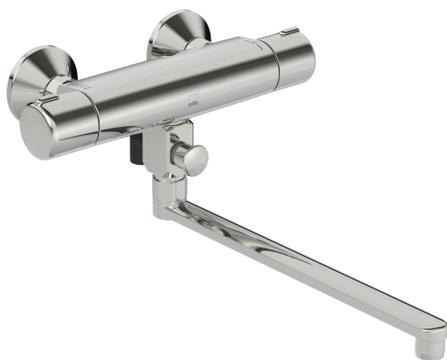
Термостатический смеситель для ванны и душа с поворотным изливом, дивертером и аэратором. Включая эксцентрики и декоративные розетки. Ограничитель температуры воды на 38°C на рукоятке. Контроль за расходом воды EcoFlow. В комплект входят обратные клапаны, грязевые фильтры и затворы.
