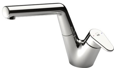
Смеситель для кухни с гибридным управлением (с однорычажной и бесконтактной функцией), с термостатическим блоком управления, поворотным вытяжным изливом и аэратором. Угол поворота излива 150° - заводская установка (может быть уменьшен до 70°). Бесконтактная функция активируется поднесением рук в зону распознавания датчика. Поток воды открывается на 6 сек., но может быть закрыт ранее повторным поднесением рук в зону распознавания датчика. Питание от батарейки 3 В. F = с гибкой подводкой
