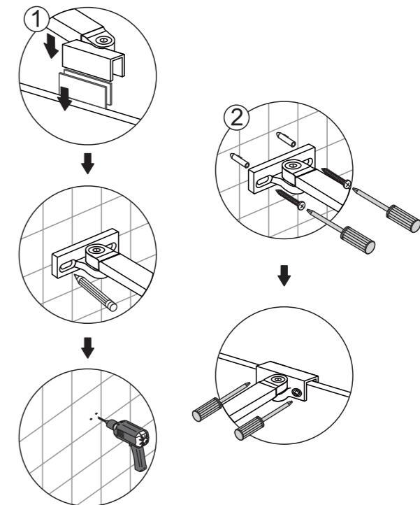
⚠ Необходимо вертикально установить стенные профили, настроить их по уровню. Колесики должны быть отрегулированы по плоскости двери и должны обеспечивать плавный ход
