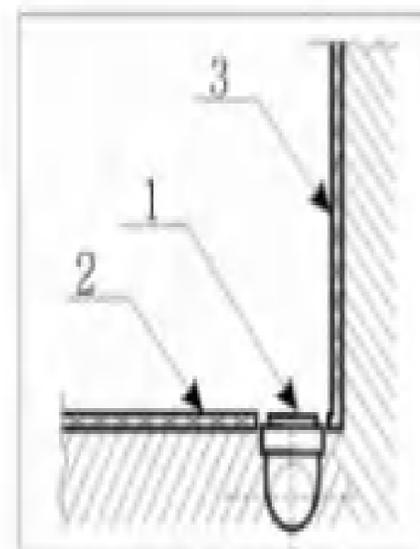
**A** - Вывод канализации устраивается в уровень с полом из стены или из пола под срез кафельной плитки.
