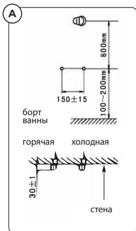
1. Трубы с горячей и холодной водой должны располагаться на расстоянии 150 мм друг от друга по центрам. Рекомендуемая высота от борта ванны до места подключения смесителя 100-200 мм (рис. А).
