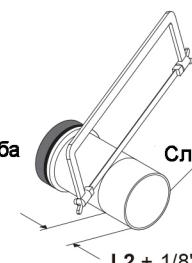
Измерьте полученную длину водопроводной трубы, прибавив 5 мм, после измерьте данное расстояние от основания трубы и отрежьте ее как показано на рисунке.
