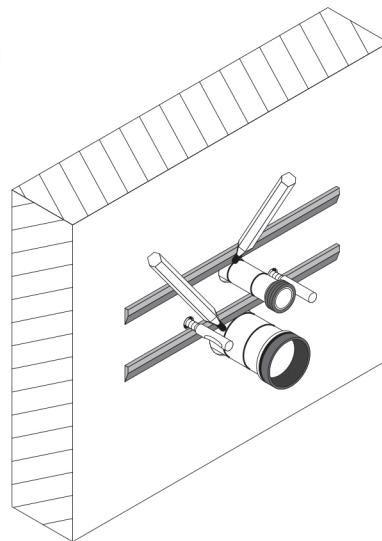
Вставьте сливную и водопроводную трубу во внутренние отверстия с отводом в стене и начертите разметку карандашом как показано на рисунке.
