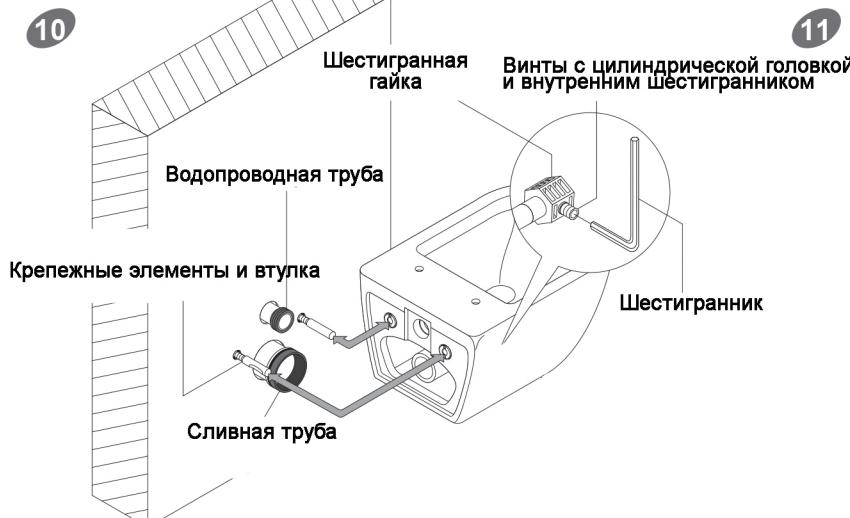
Подсоедините унитаз к стене с помощью крепежных элементов. Для этого воспользуйтесь шестигранником. Убедитесь, что сливная и водопроводная труба плотно подсоединенены к отливу.
