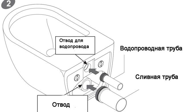
Подсоедините водопроводную трубу с уплотнительным кольцом к отливу для водопровода.
