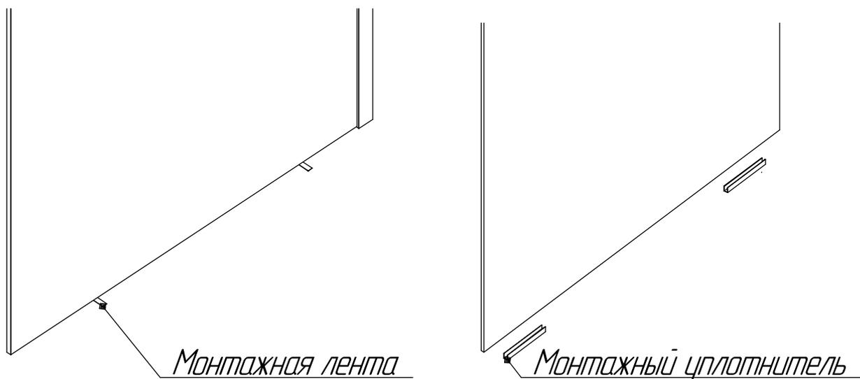
6. Разберите петли на трапециях (4) и установите стекло двери (1). Установите на стекло ручку (5). Установите магнитный уплотнитель (6) на дверцу (1) и стационарное стекло (2). Установите уплотнитель (9) на стационарное стекло. Установите уплотнитель (7) на дверцу. На низ двери установите уплотнитель (8).
