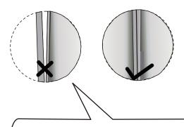
Отрегулируйте раздвижную дверь с помощью винтов на верхней части роликов. Отрегулируйте так, чтобы раздвижная дверь была параллельна неподвижным панелям.
