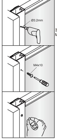
Затяните стену и дверную раму винтами M4X10.
