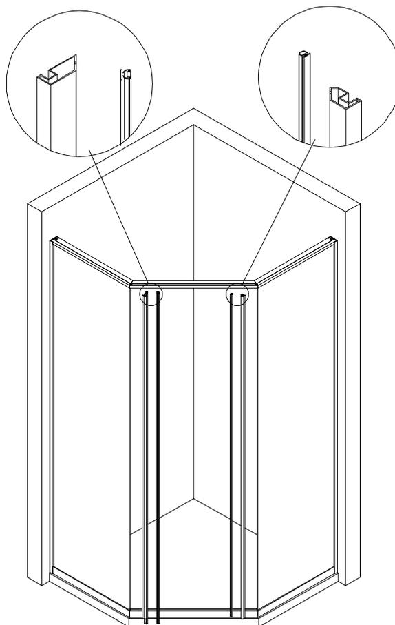
5. Проверьте надежность сборки раздвижной двери, а затем проверьте, установлены ли на место верхний и нижний ролики, а также профиль для магнитной вставки в дверной стойке. После подтверждения установите дверное стекло внутри как показано на схеме. Сначала вставьте верхний ролик в паз верхней направляющей, чтобы совместить его с роликом нижней направляющей. Поместите отрезной уплотнитель соответственно в выемки верхней и нижней направляющей.
