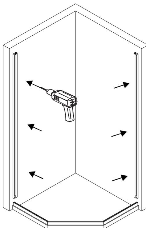
3. Установите два стационарных стекла слева и справа в пристенный профиль и паз нижней направляющей, затем совместите верхнюю направляющую с зазором с обеих сторон пристенного профиля и установите ее.
