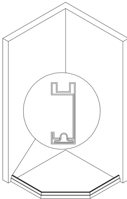
2. Поместите пристенный профиль на левую и правую стороны нижней направляющей, проверьте положение, затем нарисуйте на стене линии, просверлите отверстия и закрепите, обратите внимание на вертикальный уровень пристенного профиля.
