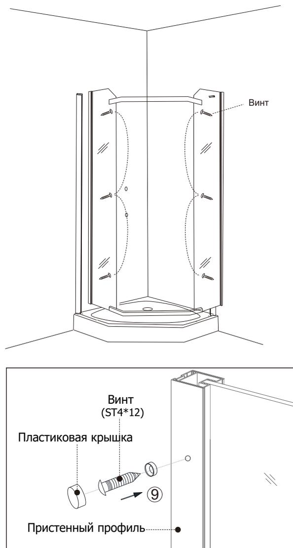
5.2) Установите кронштейн на душевой поддон и с помощью винта закрепите кронштейн в боковом стекле.
