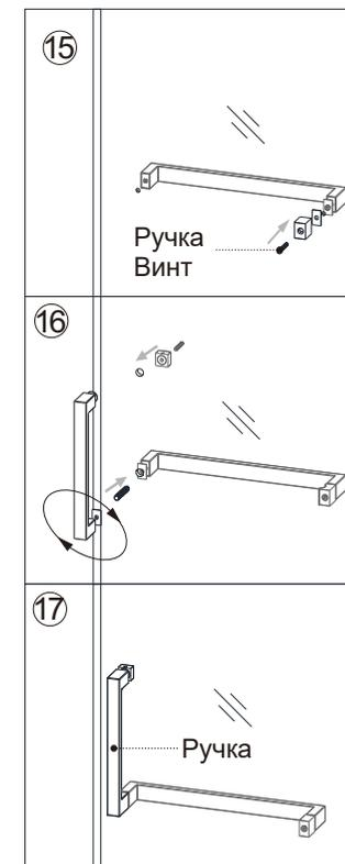
Установите дверные ручки, водонепроницаемые и магнитные уплотнители на стеклянную дверцу (согласно рисункам выше).
