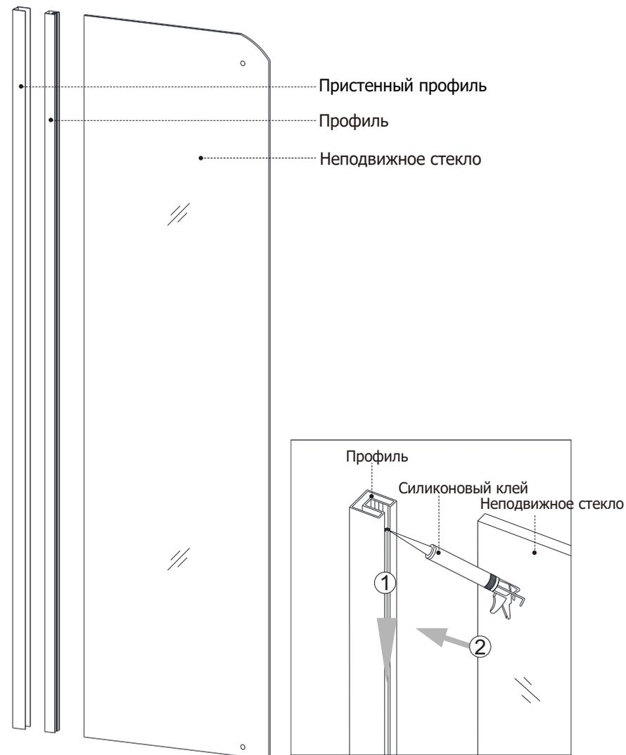
4.1) Соберите боковую стенку, установив в профиль водонепроницаемый уплотнитель и неподвижное стекло.
