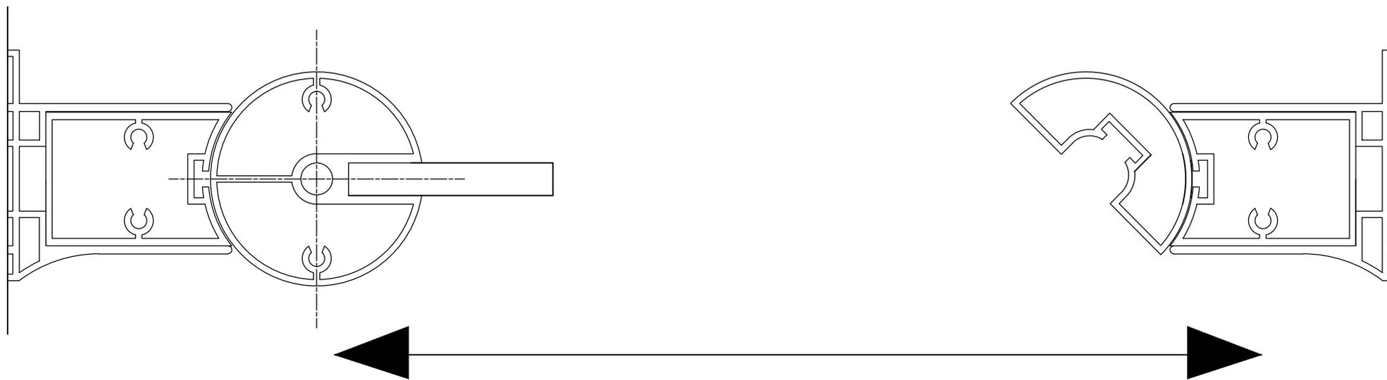
Регулировка осуществляется путем выдвигания профиля (максимально возможное выдвигание – 25 мм с каждой стороны).
