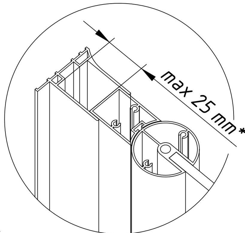
5. После регулировки ограждения и установки заглушек, необходимо зафиксировать его в установленном положении, используя саморезы.
