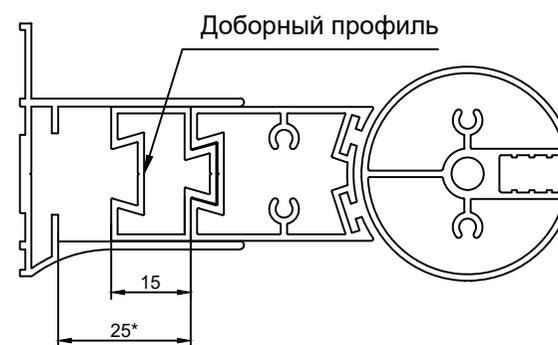
Регулировка осуществляется путем выдвигания профиля. Размеры указаны в мм.
