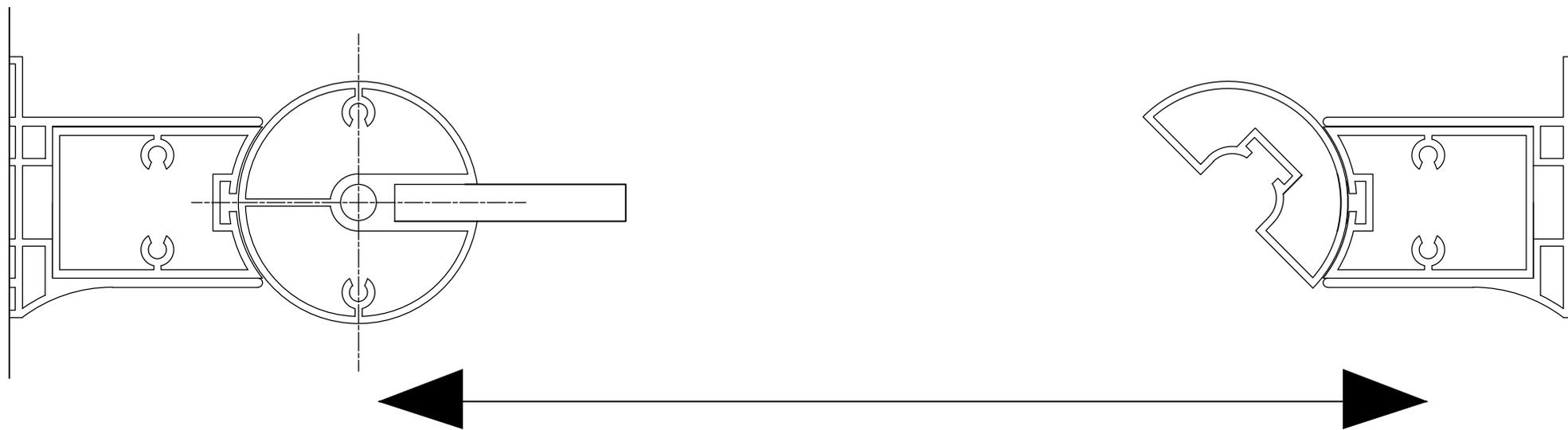
Регулировка осуществляется путем выдвигения профиля (максимально возможное выдвигение – 25 мм с каждой стороны).
