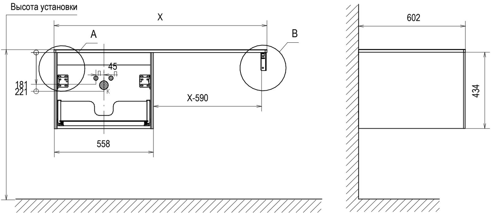
П - Подводка воды; К - Вывод канализации
